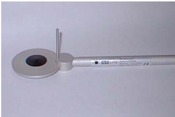
NR-LITEは野外における下向き上向き放射のバランスを測定する定置観測用放射収支計として開発されました。
