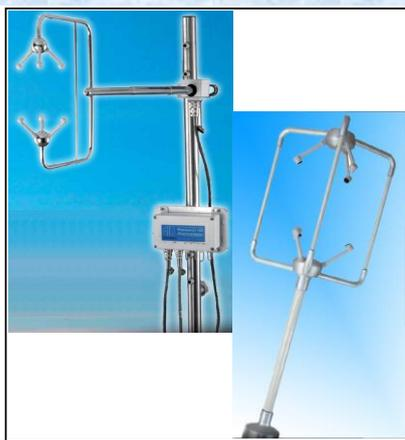
**Research**シリーズ(**R3&HS**)は渦共分散によるフラックスの研究に最適です。本シリーズはU,V,Wと音速(音仮温度)の出力が可能です。ギル社フリーソフトの**WindCom1**により、データの記録が可能です。測器の電源とアナログ出力は付属品の**PCIA**(電源・アナログ通信装置)によって供給可能です。アナログ入力は**HS**タイプには標準で付属し、**R3**タイプの場合はオプションのセンサーインプットユニット(**SIU**)を介して対応可能です。
