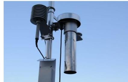
この縦型通風筒は温度湿度計用の強制通風型の通風筒で、モーターファンを上部に内蔵し強制的に通風させています。材質はステンレス鋼で仕上げ耐環境性を向上させています。
