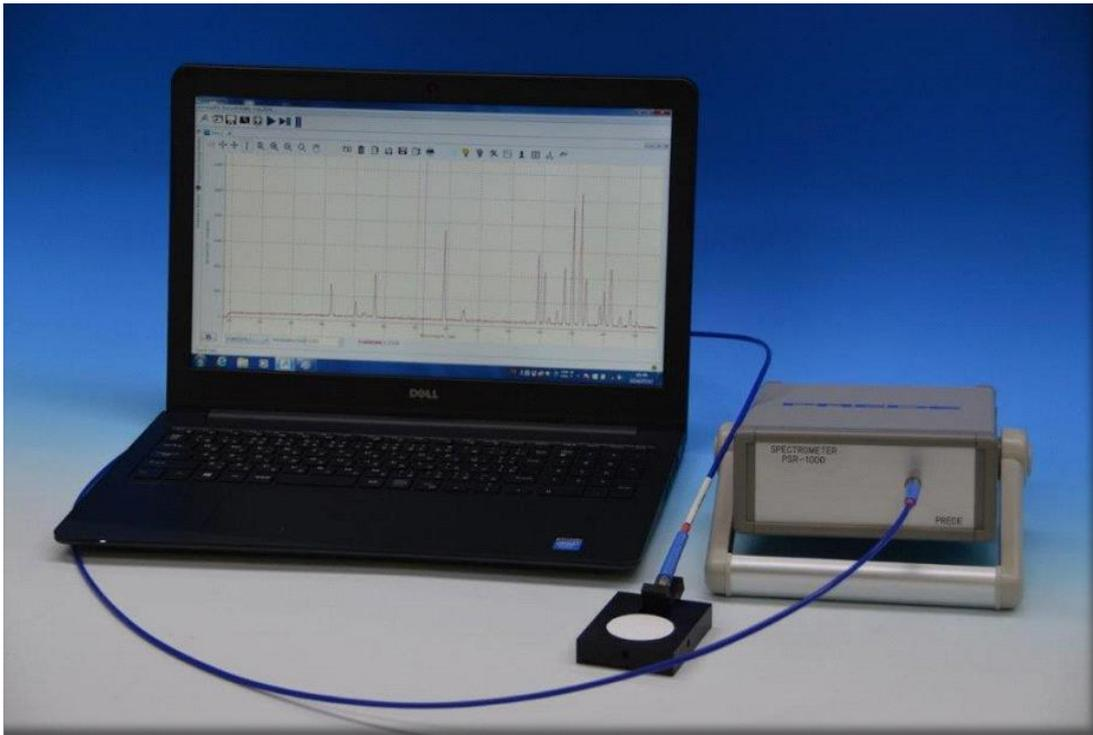
PSR-1000は、2048chのCCDアレイセンサーと小型の回折格子型分光器を内蔵した、コストパフォーマンスに優れた分光放射計です。多様な光源の絶対(相対)分光放射照度、光源色(色度座標、色温度、演色評価数)を瞬時に測定できます。オプションを使用して分光反射・透過率の他ラマンや蛍光などが測定できます。サンプル光は光ファイバーによって分光器に導入され、標準では反射型拡散板が集光用のアタッチメントとして付属されています。PSR-1000は、JCSSで検定された分光放射照度標準電球によりトレーサブルな校正が行われ出荷されます。
