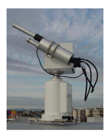
☆ 本器は、太陽周辺光及び直達分光強度を測定する装置です。受感部は太 陽追尾装置に搭載され、サンセンサーで太陽の位置を捕らえ自動追尾 が可能です。計測データはマイクロプロセッサーにより処理されパーソ ナルコンピュータに記憶されます。
