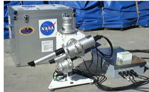
☆ 本器は、太陽周辺光及び直達分光強度を測定する装置です。受感部は太陽追尾装置に搭載され、SUNセンサーで太陽の位置を捕らえ自動追尾が可能です。計測データはマイクロプロセッサにより処理されPCに記憶されます。
